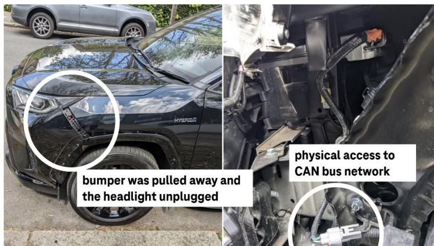
ABBILDUNG 2: DARSTELLUNG, WIE DER PHYSISCHE ZUGRIFF EINES BETROFFENEN FAHRZEUGS REALISIERT WERDEN KANN [1]
